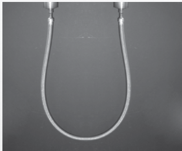
Fig. 4.1.6 Essai de fatigue sous pression interne.
