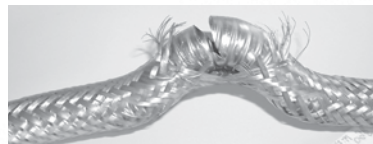
Fig. 4.1.2 Défaillance de la tresse et rupture consécutive du tuyau
